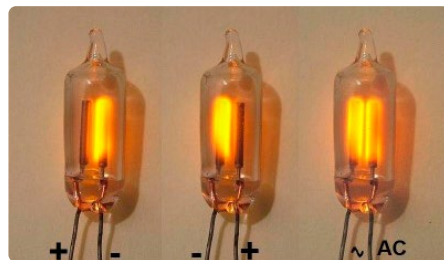
Figure 3. Lampes au néon alimentées en courant continu en inversant les polarités, et en courant alternatif CA, respectivement. Source : https://commons.wikimedia.org/wiki/File:Neonlamp3.JPG , "Neonlamp3," https://creativecommons.org/licenses/by-sa/3.0/legalcode
