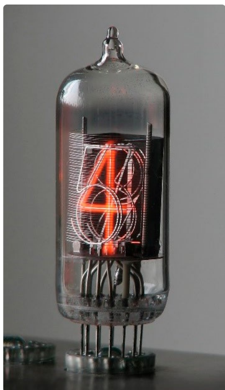
Figure 4. Tube Nixie avec la cathode « 4 » allumée. Généralement, un filtre rouge ou orange est utilisé pour améliorer le contraste. Source : Georg-Johann Lay with a slight edit by Richard Bartz ( https://commons.wikimedia.org/wiki/File:ZM1210-operating_edit2.jpg ), "ZM1210-operating edit2," https://creativecommons.org/licenses/by-sa/3.0/legalcode
