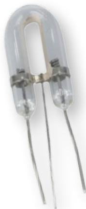
Figure 5. Tube à éclats. L'électrode de déclenchement est le fil du milieu, relié à deux bandes situées à l'extérieur du verre. Source : Jaycar Electronics (Australia). Utilisé avec permission.
