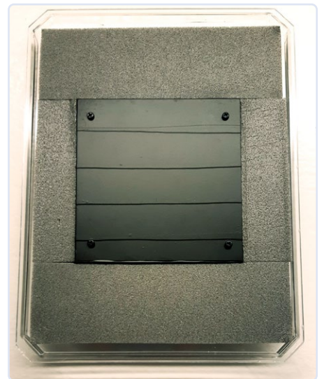
Figure 6. Plaque de cuivre noire entourée d'une feuille d'acrylique. J'ai recouvert l'acrylique d'un peu plus d'isolant pour assurer l'étanchéité de la cloche transparente.
