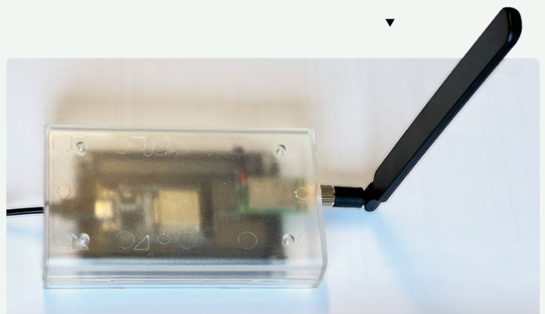
Figure 10. Le premier prototype (sans écran) logé dans un boîtier semi-transparent avec une antenne externe de 2,4 GHz.
