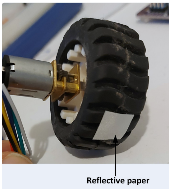
Figure 11. Fixation d'un morceau de papier réfléchissant sur l'arbre du moteur.
