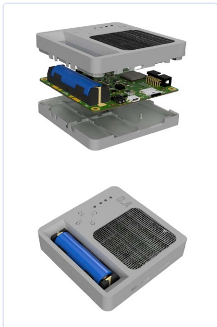
Figure 4. Simple, intelligent et abordable, le testeur « Battery Cyclor » permet les échanges entre membres de la communauté expérimentant les batteries.
