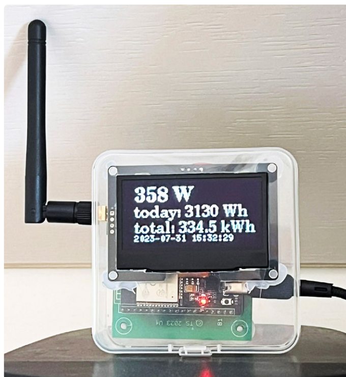
Figure 11. Mon DTU que j'ai construit moi-même avec un écran OLED de 2.42 pouces.
