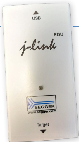
Figure 3. Dans de nombreuses situations (mais pas toutes), un programmeur/débogueur JTAG ou SWD est nécessaire pour vos expériences Zephyr.
