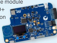
➤ **Nucleo-WL55JC** est une carte d'évaluation pour les microcontrôleurs de la famille STM32WL, et en particulier pour le STM32WL55. Ce microcontrôleur sans fil dit sub-GHz est basé sur un Arm Cortex-M4/M0+ 32 bits à double cœur avec une fréquence d'horloge de 48 MHz. Elle se caractérise par une très faible consommation d'énergie, un émetteur-récepteur RF avec une plage de fréquences de 150 MHz à 960 MHz, 256 Ko de mémoire Flash et 64 Ko de SRAM.
