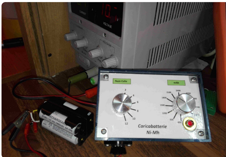
Figure 4. Le chargeur terminé en cours de fonctionnement avec un pack de
