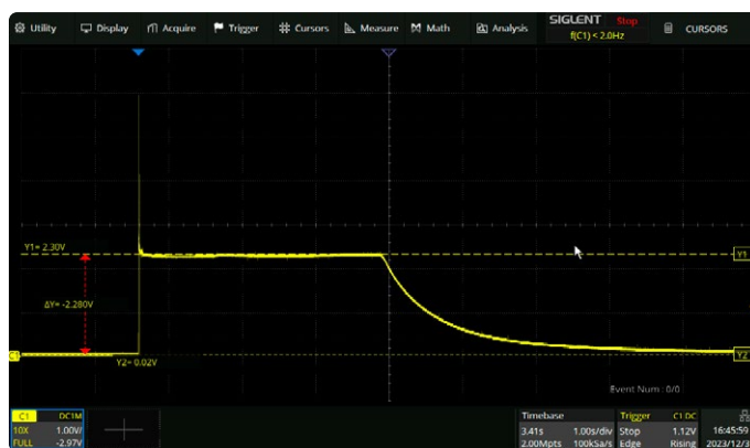
Figure 4. Charge du supercondensateur mesuré sur R1.
