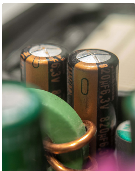
Figure 4. Les fameux condensateurs électrolytiques bombés. (Source : Wikipédia [3])
