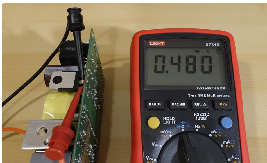
Figure 5. Utilisation du mode diode pour tester un MOSFET de puissance.
