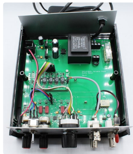
Figure 4. Circuit imprimé assemblé du prototype, installé dans son boîtier.
