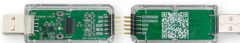
Figure 4. WCH-Link, l'outil utilisé pour la programmation et le débogage. (Source : WCH [15])
