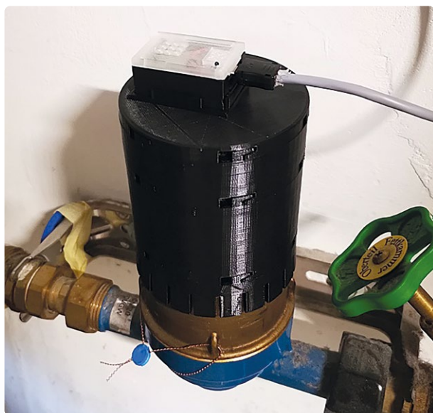
Figure 5. Un adaptateur a été fabriqué avec l'imprimante 3D, pour installer l'ESP32-CAM sur le dessus du compteur.
