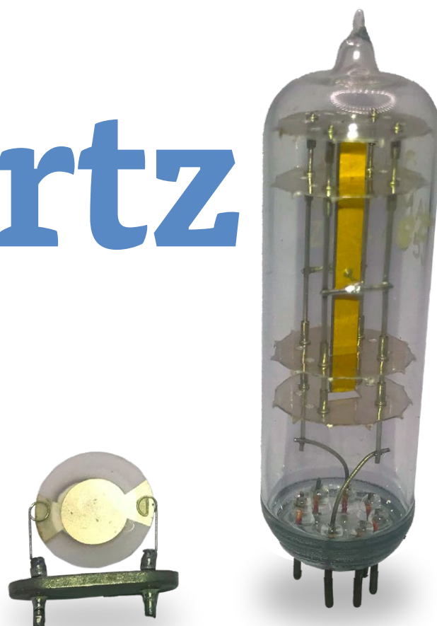
Figure 1. Un petit disque de quartz de quelques MHz datant de 1975 et un plus grand quartz de 100 kHz en forme de barre datant de 1959.
