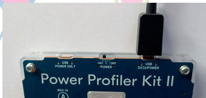
Figure 5. Connectez le Power Profiler Kit II à votre PC.
