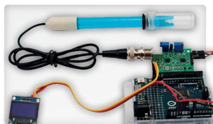
mesure du pH avec l'Arduino UNO R4
