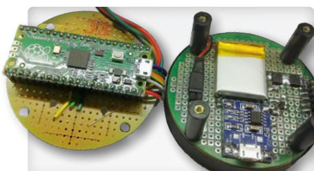
niveau à bulle électronique et disque
