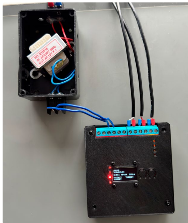
Figure 3. Transformateur abaisseur de tension 220 V à 12 V dans un boîtier personnalisé.
