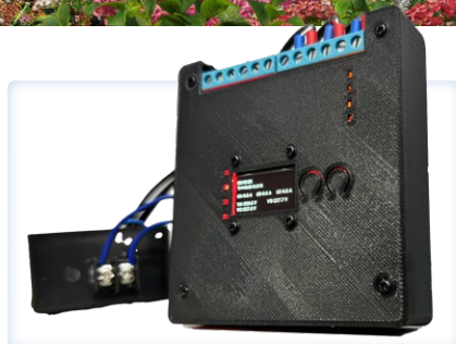
compteur d'énergie ESP32 intégration dans Home Assistant
