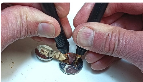
Figure 4. Voici la façon de souder. Appuyez modérément et attendez quelques secondes.
