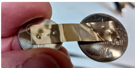
Figure 5. Souder un ruban de nickel à une pile bouton.
