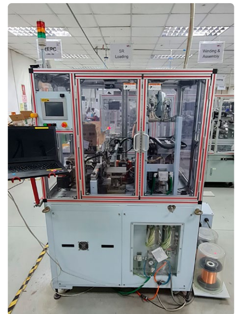
Figure 4. Machine à module de soudage pour le rétroéquipement.
