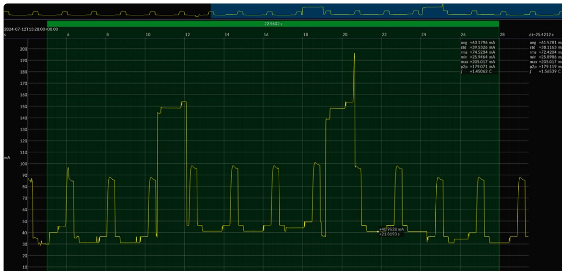
Figure 10. Forme d'onde du courant du SCD30 et du module LoRa.
