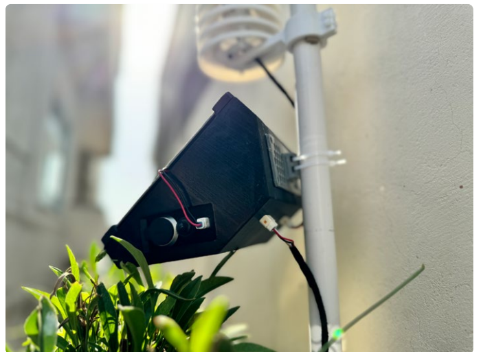
Figure 16. Vue latérale de la nœud de capteur LoRa d'installation, montrant le connecteur étanche de type USB Type et les connecteurs étanches JST.
