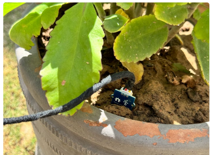
Figure 3. Le capteur de sol. Il peut provoquer un court-circuit s'il attrape de l'humidité.
