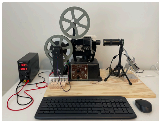
▲ Figure 3. Configuration d'un numériseur de film « maison ».
