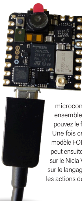
Figure 1. Avec des dimensions de 22,86 mm × 22,86 mm × 7,26 mm, l'Arduino Nicla Vision est la plus petite caméra OpenMV disponible sur le marché.
