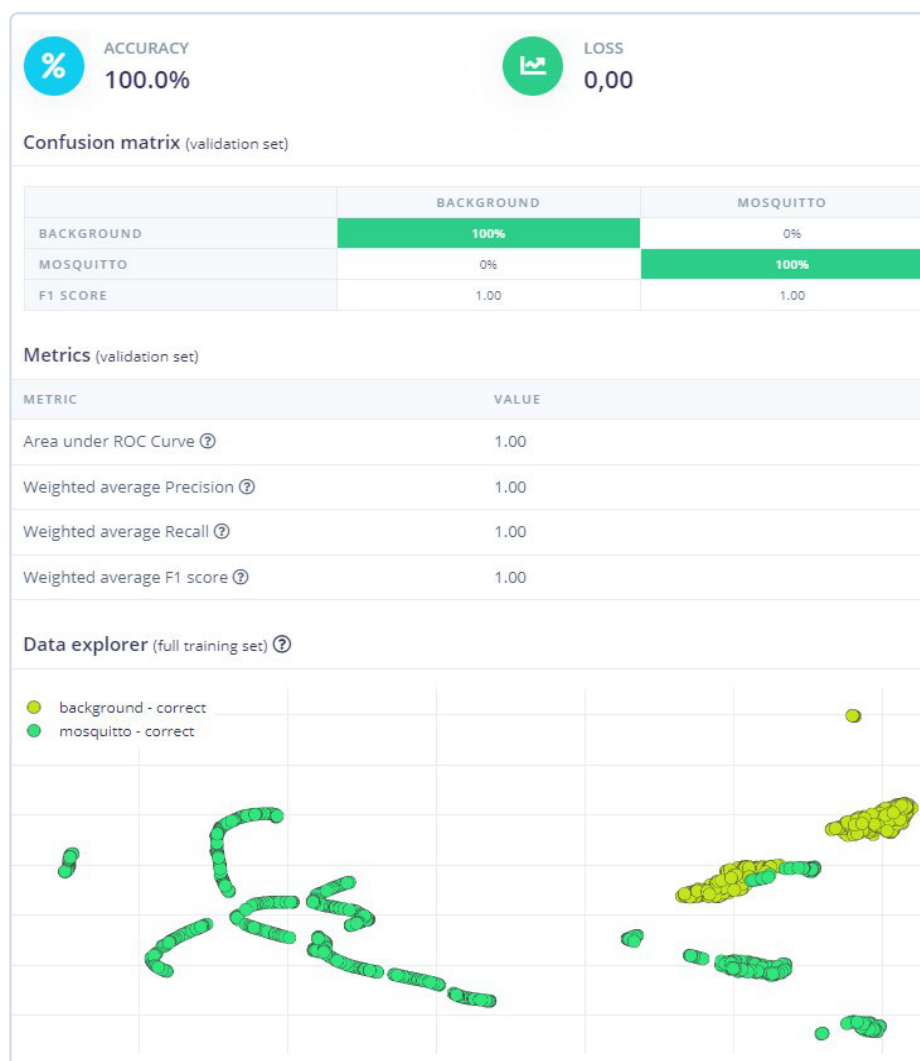
Figure 14. Le modèle a atteint une précision de 100 % et un score F1 parfait de 1,00, avec des groupes bien séparés pour les sons de moustiques et les sons de fond, ce qui le rend prêt pour une utilisation pratique.
