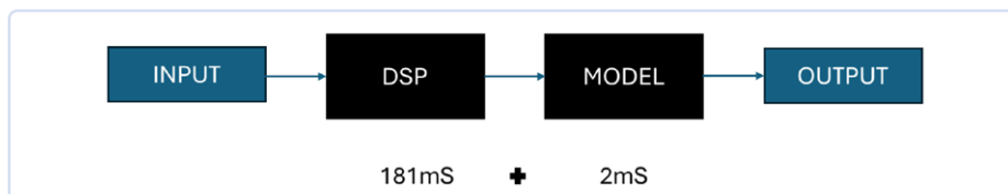
Figure 12. Le bloc DSP s'exécute en temps réel, avec une latence totale de 183 ms par inférence sur le Nicla Vision.
