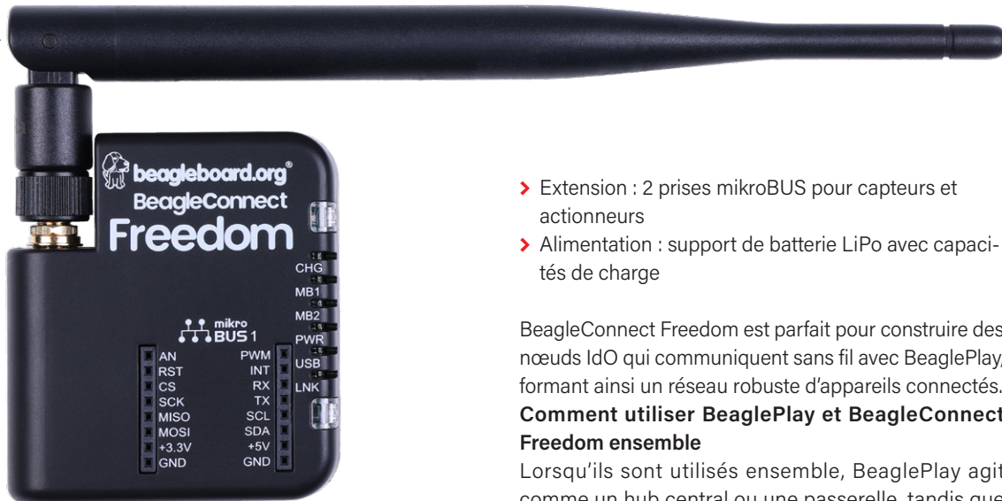
Figure 5. BeagleConnect Freedom, une plateforme sans fil avec le microcontrôleur TI CC1352P7, prend en charge les nœuds IdO longue portée avec le protocole BLE et Sub-1 GHz.
