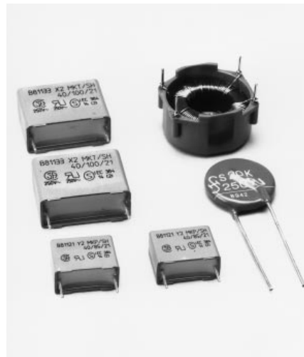
Figure 8. Seuls ces composants spéciaux peuvent prendre place dans un filtre secteur.
