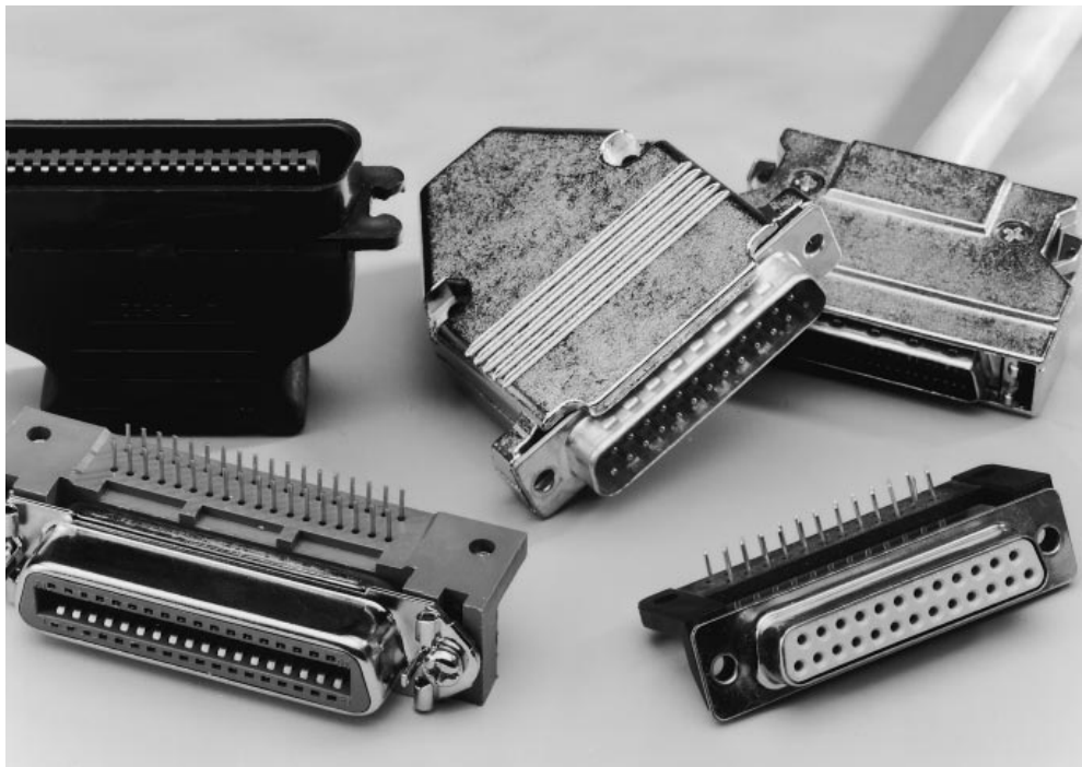
Figure 4. Photo des 3 types de connecteurs que connaît IEEE 1284.
