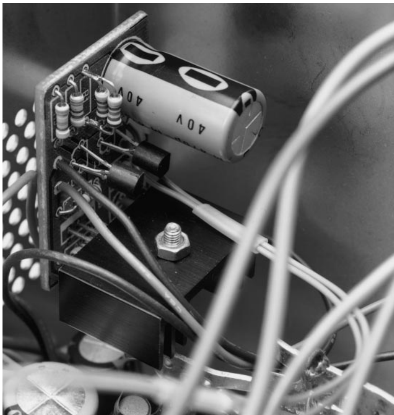
Figure 5. On voit ici comment implanter le montage et son capteur dans l'alimentation d'un ordinateur.
