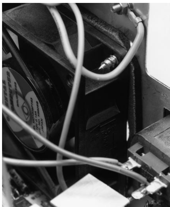
Figure 2. L'insertion, entre le ventilateur et le boîtier, d'un joint de caoutchouc permet d'atténuer fortement la transmission de vibrations
