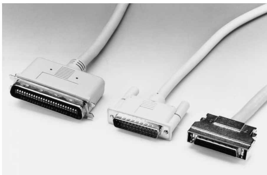
Figure 2. La qualité des câbles SCSI utilisés et les connecteurs jouent un rôle important dans la qualité d'un système. Ces 3 variantes de connecteurs servent dans la grande majorité des configurations standard.
