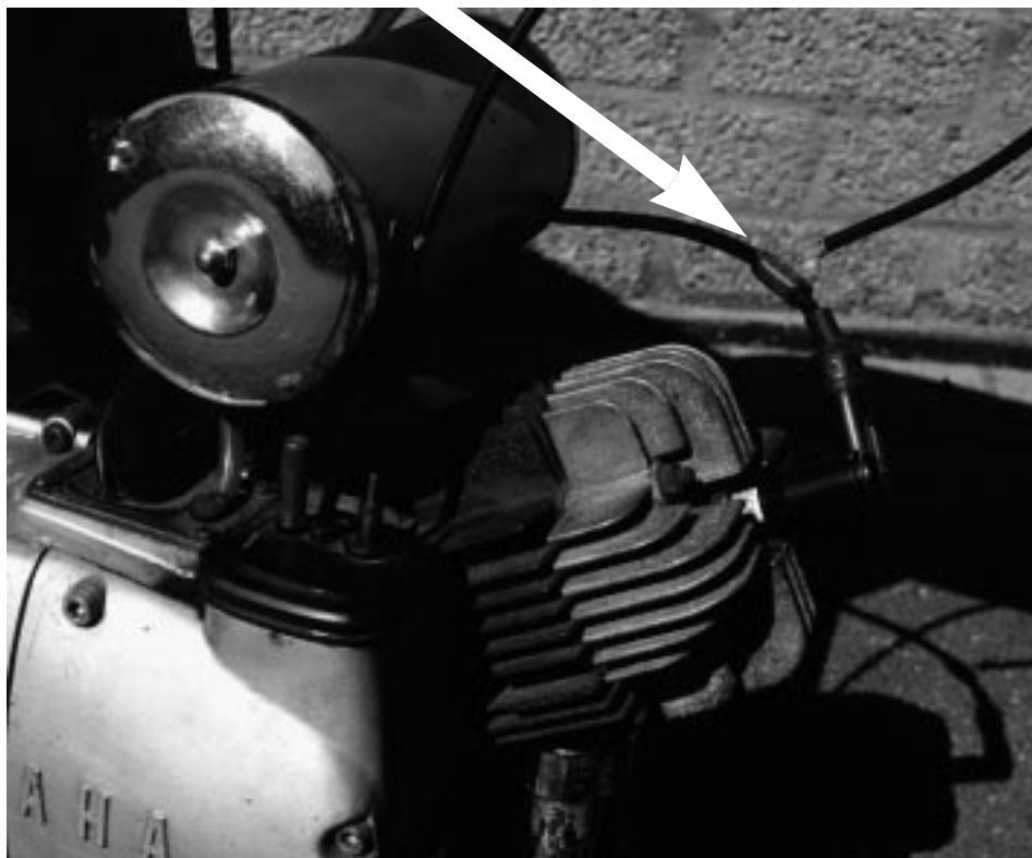
Figure 4. On voit ici très bien les 20 spires du capteur bobinées sur le câble d'allumage.
