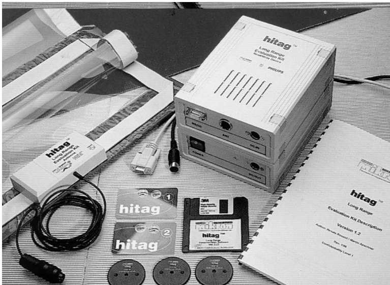
Figure 9. Il existe des kits de développement et de démonstration pour la réalisation de systèmes à transpondeurs.
