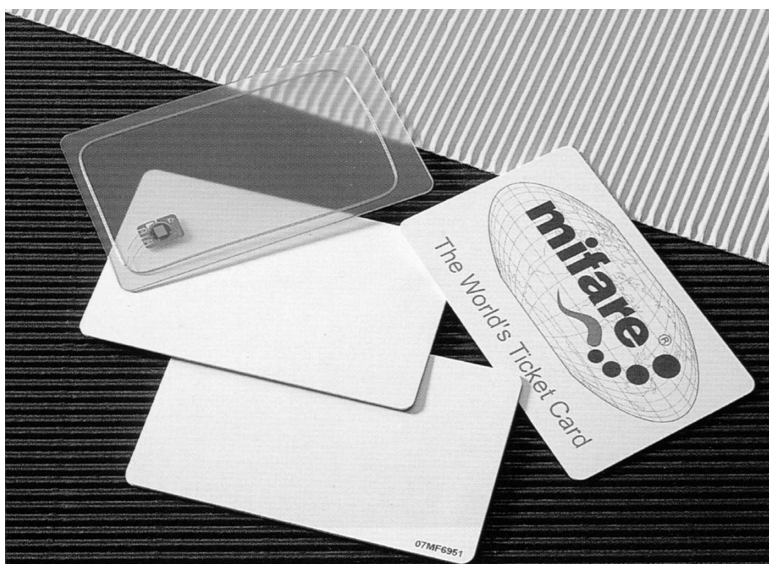
Figure 5. Une carte à mémoire sans contact constitue un support de données polyvalent dont les fonctions sont assurées par la puce et l'enroulement sous plastique.
