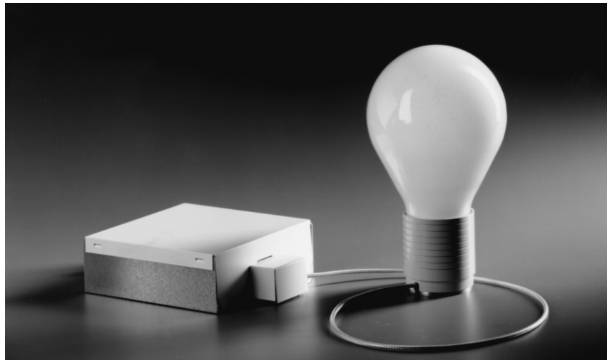
Figure 2. Philips a appliqué le principe théorique de l'ampoule à induction à cette ampoule QL. Le générateur HF distinct est relié à l'électronique présente dans le ballon par le biais d'un câble coaxial.
