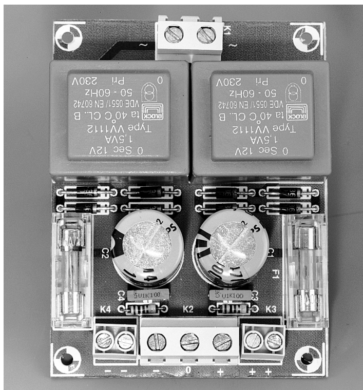
Figure 5. Vu les dimensions extrêmement compactes de l'alimentation auxiliaire, il ne devrait pas y avoir de problème pour lui trouver une place à l'intérieur du coffret.
