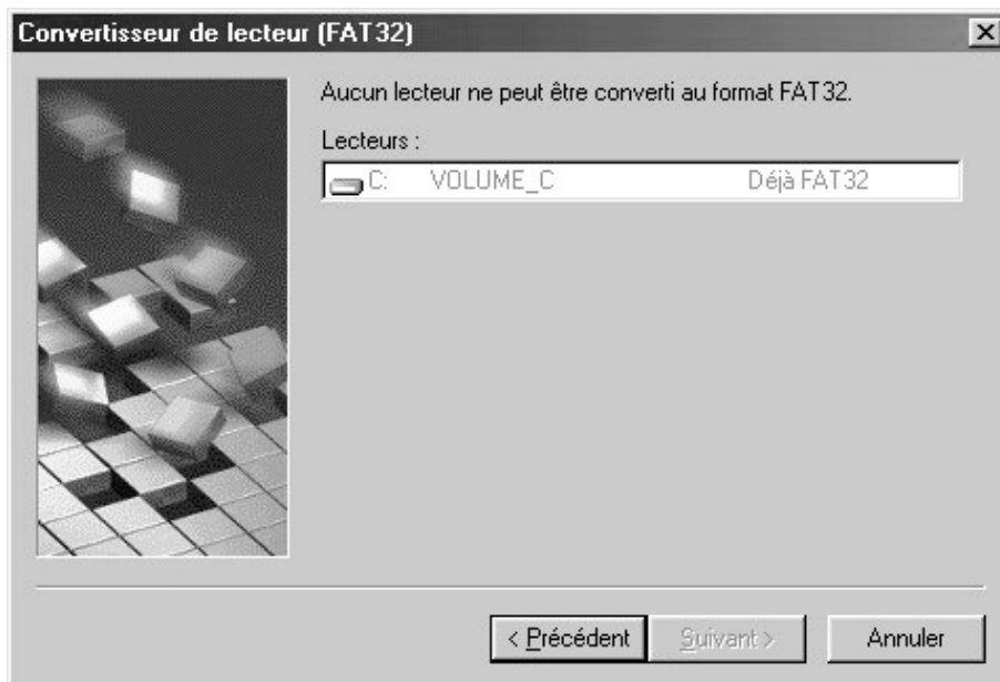
Figure 4. Le programme Drive Converter de Windows 98 permet, après coup, de convertir une partition FAT16 en partition FAT32.
