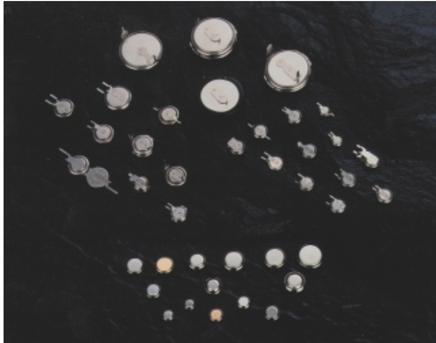
Figure 1 Les piles boutons rechargeables ion-lithium ont de bonnes chances de conquérir le marché des batteries de sauvegarde. Avantages : faible autodécharge – et 3,6 V par cellule !
