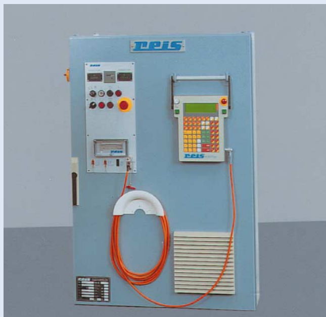
Figure 5. Programmeur manuel et tableau de commande dans une armoire de commande (Reis Robotics).
