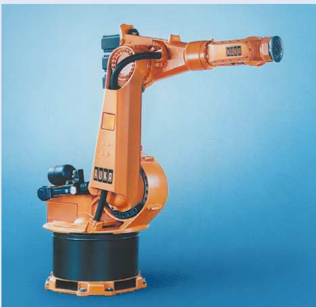
Figure 4. Robot à bras articulé verticalement (robot Kuka).
