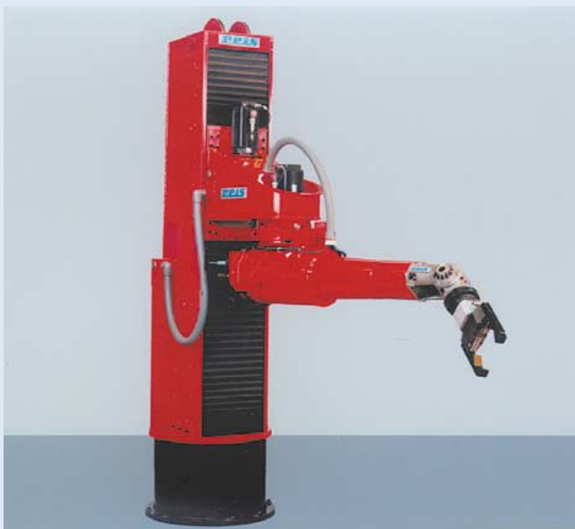
Figure 3. Robot à bras articulé horizontalement (Reis Robotics).
