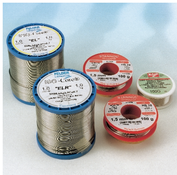
Figure 2. Quelques « échantillons » : les grosses bobines contiennent des alliages eutectiques d'étain/argent/cuivre qui ne se différencient qu'au niveau du pourcentage de flux (décapant), 3,5% pour le soudage au fer et 1% pour le soudage des CMS. Les bobines moyennes contiennent de la soudure étain/argent et étain/cuivre, la bobine la plus petite étant à nouveau de la soudure trimétaux (étain/argent/cuivre).
