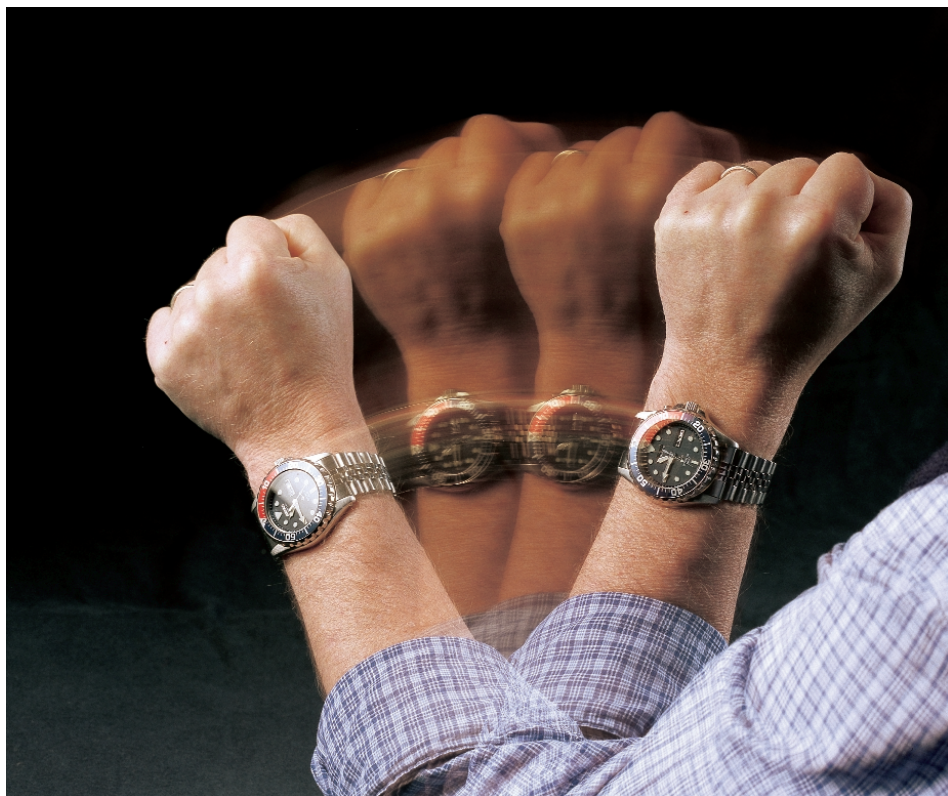
Figure 1. Qu'il s'agisse des montres automatiques ou « kinetic », l'énergie produite par les mouvements est transformée en réserve de marche pour le mouvement de la montre. Finies les piles !
