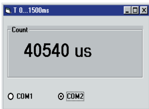
Figure 9. Mesure du temps de charge avec une résolution de l'ordre de microsecondes.
