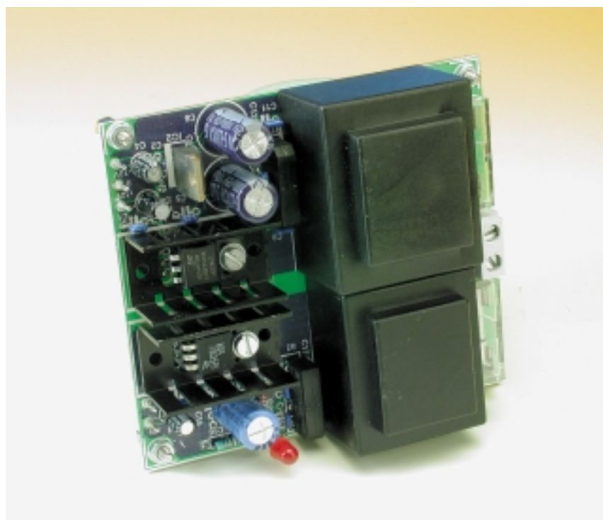
Figure 5. Les régulateurs IC1 et IC3 seront dotés d'un radiateur de petites dimensions.
