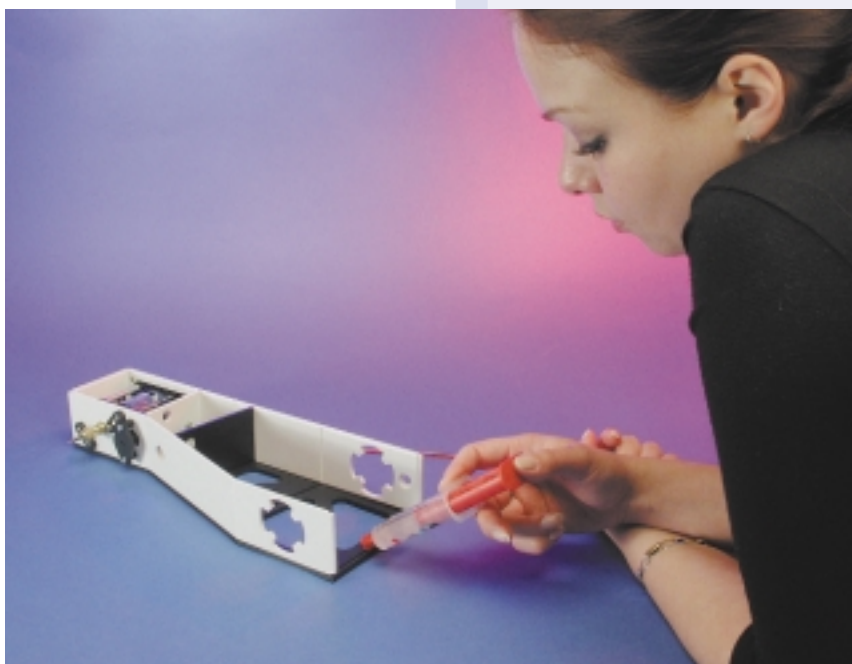
Figure 2. Le collage se fait par mise en place d'une « cordelette » de colle sur toute la longueur de la rainure de collage.
