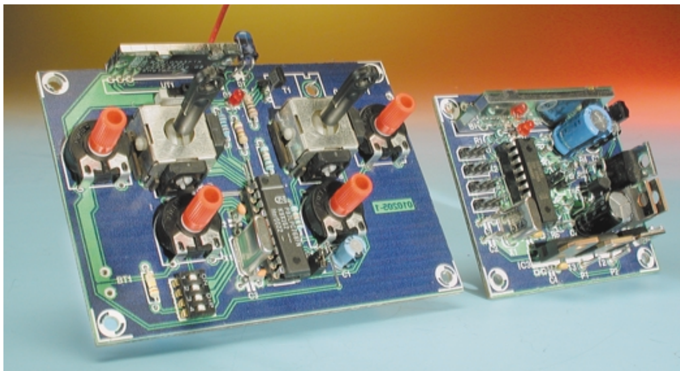
Figure 4. Les modules 433 MHz utilisés pour l'émetteur et le récepteur.
