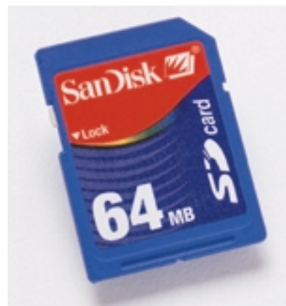
Figure 6. Dernier-né des modules de mémoire, le SDC permet de protéger les fichiers.
