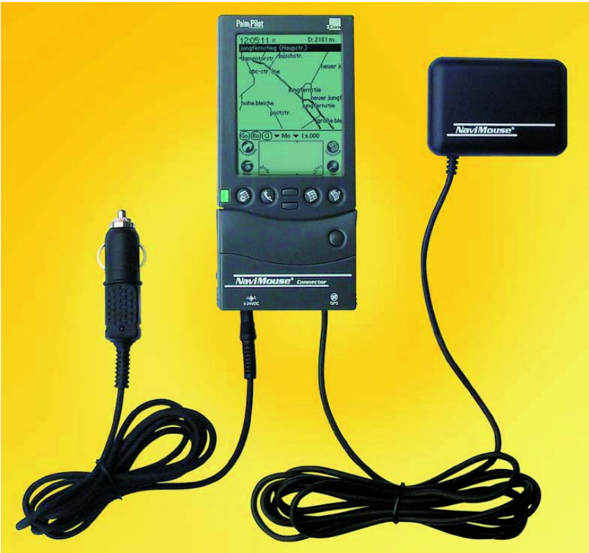
Figure 5. Une souris GPS intègre un récepteur GPS complet à antenne intégrée et pourra, selon sa version, être connectée directement à un port sériel ou USB de PC. La présente photo montre une NaviMouse (Unitronic) destinée à être connectée à un APN de l'écurie Palm.
