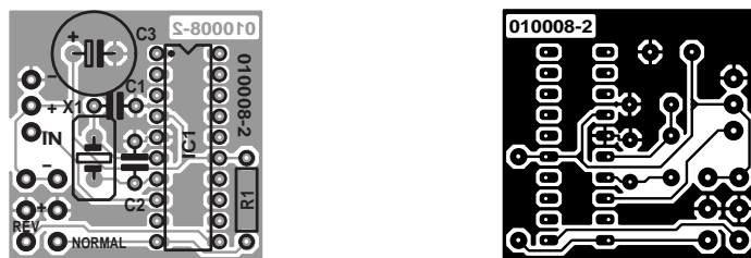
Figure 6. La platine dessinée pour le schéma de la figure 5, avec les fonctions servoreverse, filtre et câble en V.
