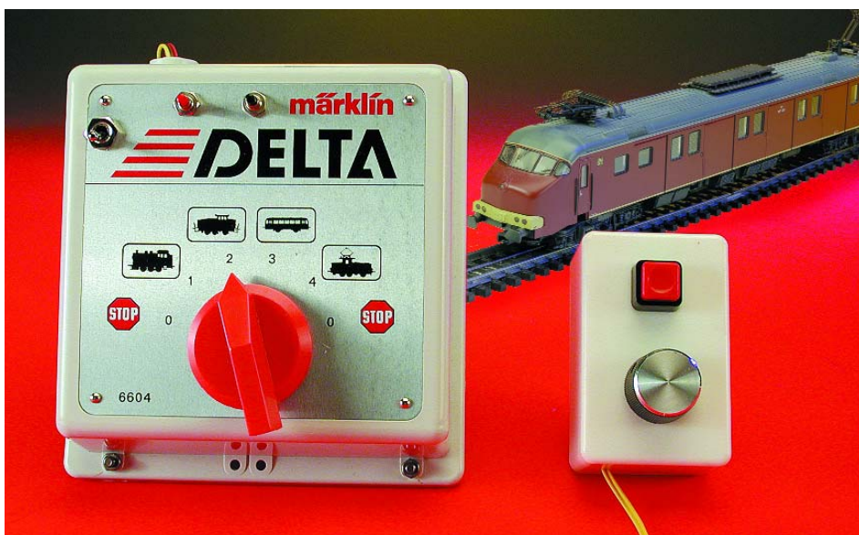
Figure 1. L'électronique du régleur manuel ne comporte pas plus de 3 composants passifs.
