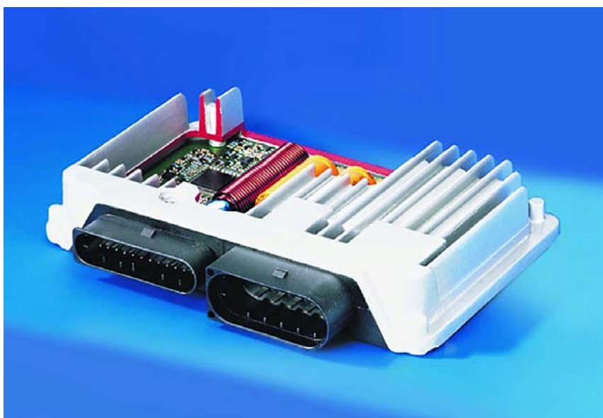
Figure 4. Pas pour le chip tuneur indépendant : bloc électronique VDO pour commande variable des soupapes de BMW (figure : Siemens).
