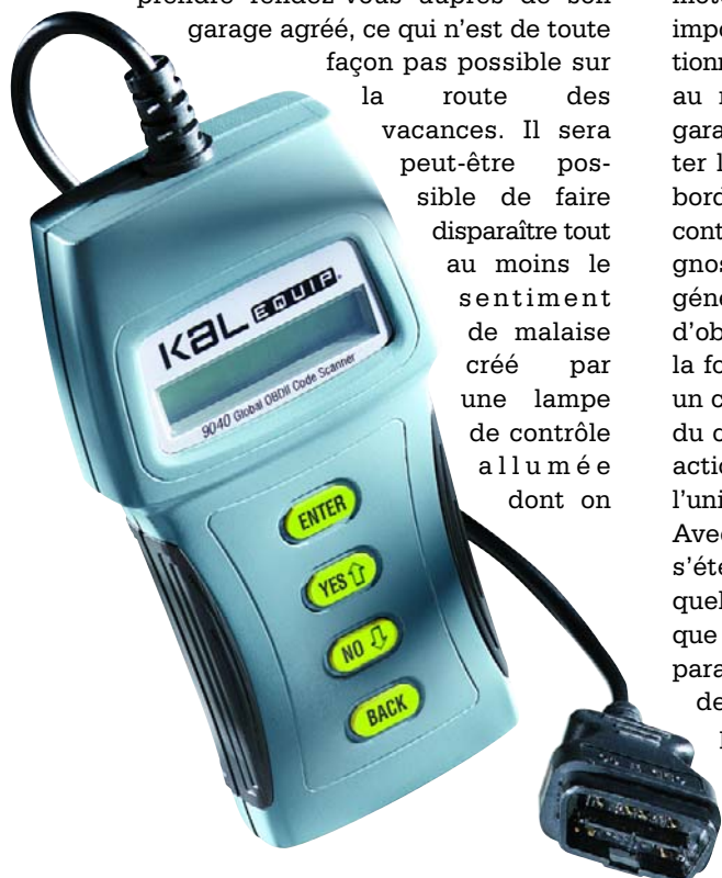
Figure 4. Terminal portatif typique permettant de relever les codes d'erreur (source : Actron Manufacturing Company, Cleveland, Ohio).
