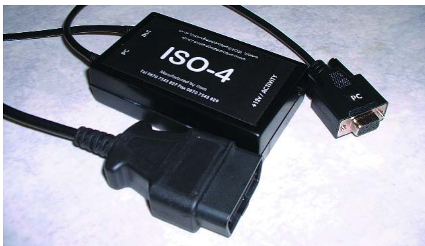
Figure 6. Outre le logiciel PC, on a besoin d'un câble d'adaptation approprié comportant un microcontrôleur de conversion d'interface (source : onboarddiagnostics).
