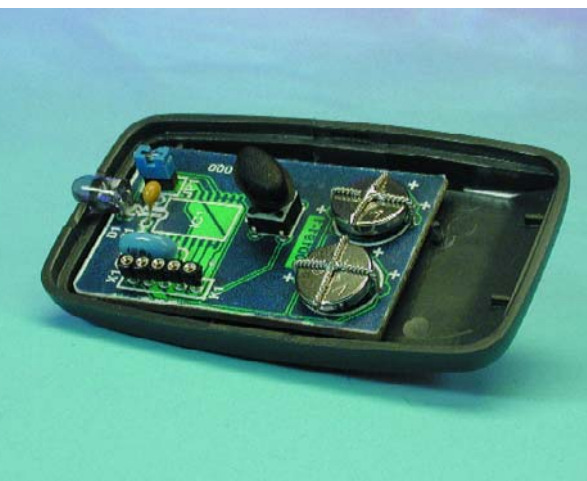
Figure 4. Ce mini-boîtier paraît avoir été conçu tout spécialement à l'intention de la platine de l'émetteur.
