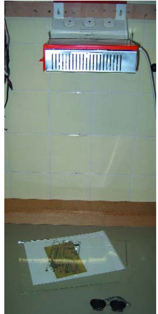
Figure 2. Insolation grâce à une bonne vieille lampe pour bronzage.
