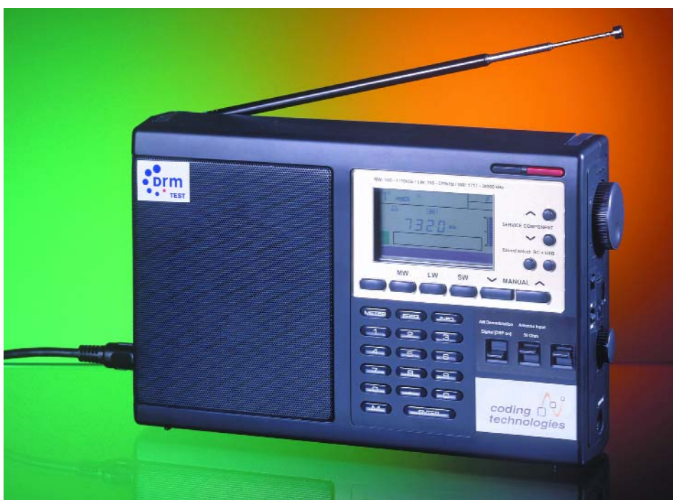
Figure 5. Le prototype de récepteur DRM (Coding Technologies).
