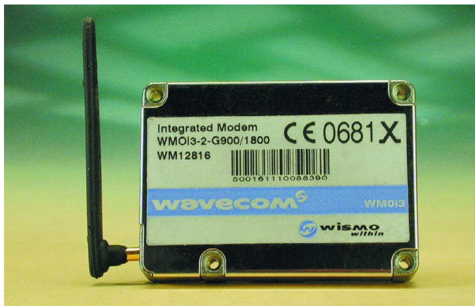
Figure 1. Le coeur (et le cerveau) de notre projet : le modem GSM programmable.
