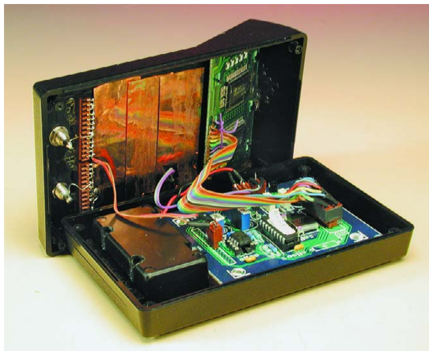
Figure 4. Coup d'oeil dans le boîtier. Le blindage prenant la forme d'une petite épaisseur de tôle de laiton est optionnel et ne sera requis que dans un environnement pollué d'interférences.
